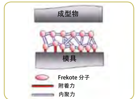
半永久性脱模剂在模具表面形成一层低表面能膜
