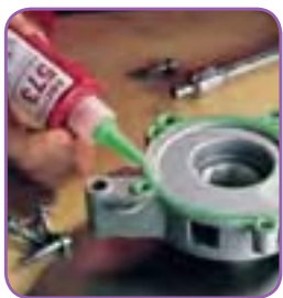
Loctite® 573 该产品适用于大间隙的金属法兰, 固化缓慢, 适用于延时作业的装配。
